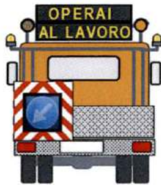
Figura 7: esempio di autocarro con PMV alfanumerico e disco direzione obbligatoria interamente a led.
