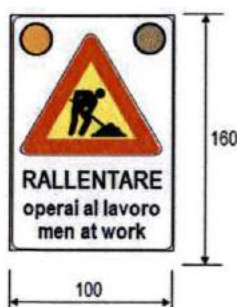
Figura 18: pannello composito di presegnalazione per lavori eseguiti lungo le corsie di decelerazione o sulle rampe di svincolo, dotato di 2 lampade a led ad alta efficienza diam. 200 mm. Superficie della targa non inferiore a 1,5 mq con lato del triangolo lavori in corso non inferiore a 90 cm. Posizionamento sul margine destro in coincidenza dell'ago di inizio della decelerazione e ripetuto in condizioni di non perfetta visibilità.
